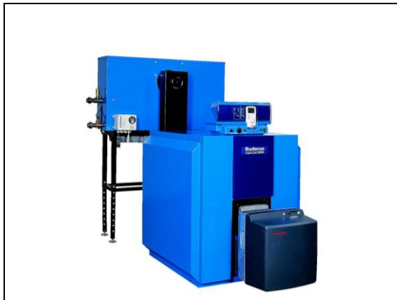
Logano GE315 & GE515 Plus med kondenskytare för gas alternativt olja höjer årsverkningsgraden 5-12%.
